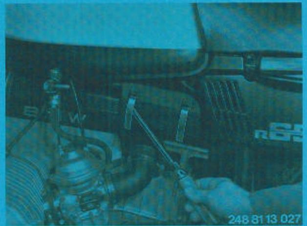
Plattenfilter herausziehen und neues Filterelement einschieben. Luftfiltergehäusedeckel mit Klammern wieder befestigen, dabei auf richtigen Sitz des Filters achten.
