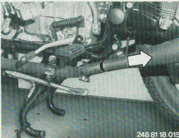
Schalldämpfer nach hinten abziehen.
