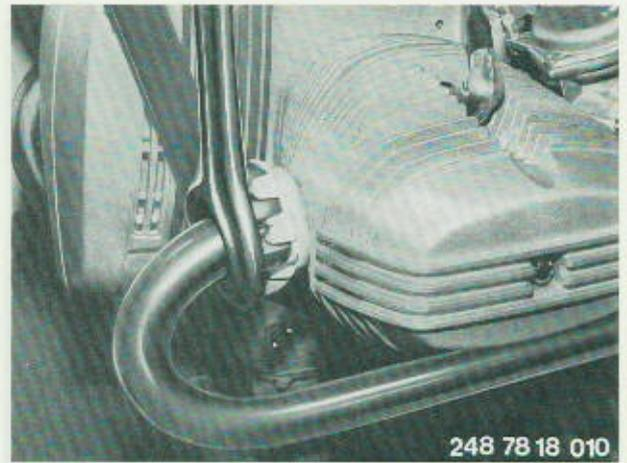
Innensechskantschrauben am vorderen Ausgleichsrohr lockern (Pfeile).
