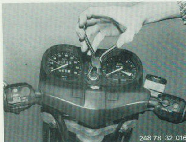
Je 2 Sechskantschrauben (Pfeile) der Lenkerbefestigung lösen.
