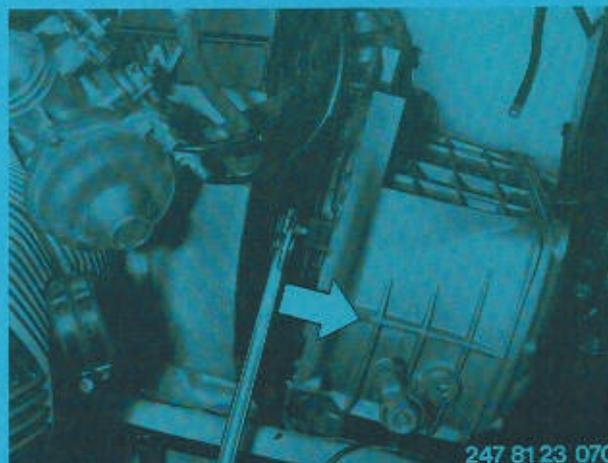
Manschette am Getriebedeckel lösen und mit Feder abnehmen. Getriebe so weit zurückziehen, daß Druckstange sichtbar wird. Mit Zange die Druckstange durch das Getriebe so weit zurückschieben, bis sich das Getriebe herausheben läßt, Druckkolben und Drucklager mit Lappen auffangen.
