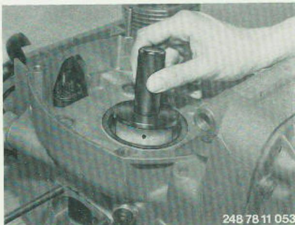
Einpreßdorn mit Kunststoffbuchse von Vorrichtung BMW-Nr. 11 2 710 in Lagerbuchse einsetzen. Darauf achten, daß die im Gehäuse überstehenden Fixierstifte nach Einpressen der Lagerbuchse in die Aussparungen am Umfang des Einpreßdornes ragen. Die Lagerbuchse ist so bemessen, daß sie in der Lagerbohrung im Gehäuse beidseitig etwas zurücksteht.
