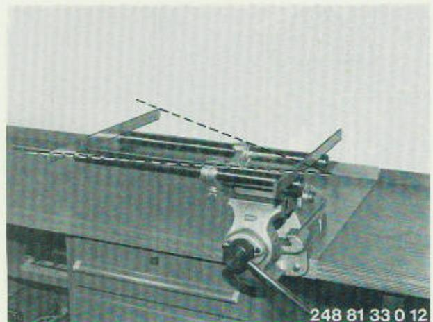
Parallelität der Standrohre mit Schieblehre prüfen. Gabelführungsrohr zu den Standrohren auf genaue Flucht prüfen. Die obere Gabelbrücke muß sich auf Standrohre und Gabelführungsrohr gleichzeitig leicht aufchieben lassen.
