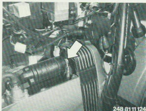
Motor ganz zurücksetzen, anheben und in Fahrtrichtung nach rechts neigen, dann aus Fahrgestell herausheben.
