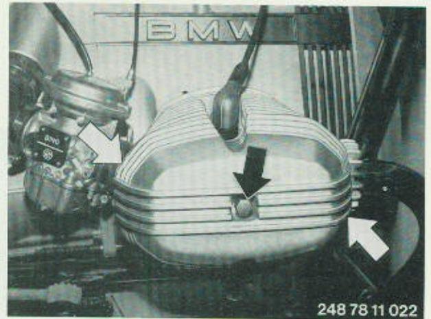
Beide Kipphebel nach Lösen der 4 Bundmutter von den Zugankerschrauben abnehmen und Stößelstangen herausziehen.
