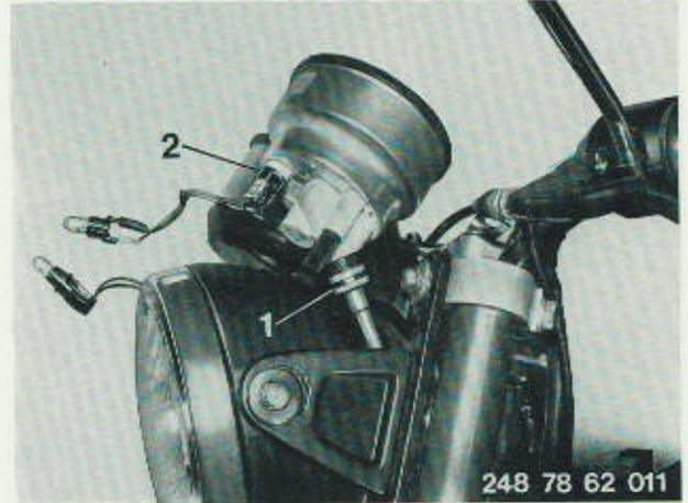
Zwei Sechskantmuttern (Pfeile) der Instrumentbefestigung
