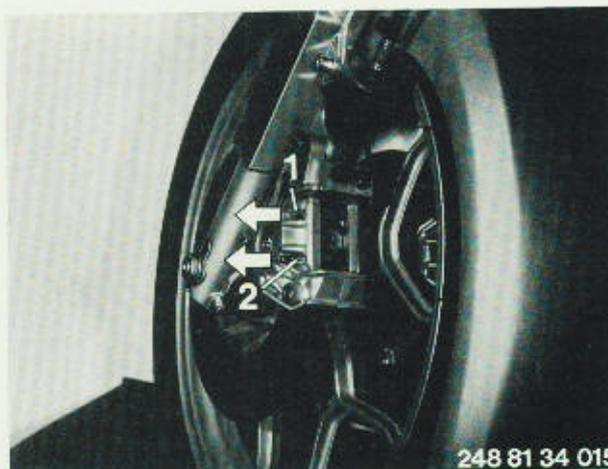
Um Riefenbildung auf der Bremsscheibe zu vermeiden, müssen die Bremsbeläge – Mindestbelagdicke in mm siehe Abbildung – rechtzeitig ersetzt werden.
