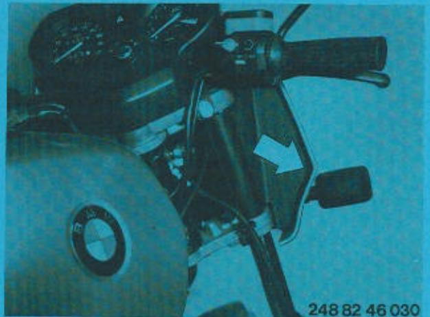
Innensechskantschrauben der Klemmstücke (Pfeil) links und rechts lösen.
