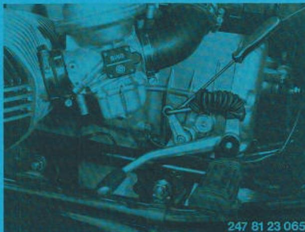
Schlauchschellen an Luftleitungen links und rechts lockern und nach Zurückschieben der Gummimuffe abnehmen. Linken Vergaser am Zylinderkopf lösen.
