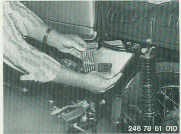
Spanngummi links in Pfeilrichtung nach unten, rechts nach oben ziehen und aushängen. Abdeckung abnehmen und Kabel an Batterie abklemmen.
