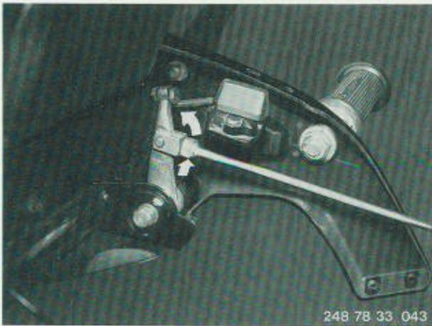
Sicherungsbolzen von der Brems-Zugstange lösen.
