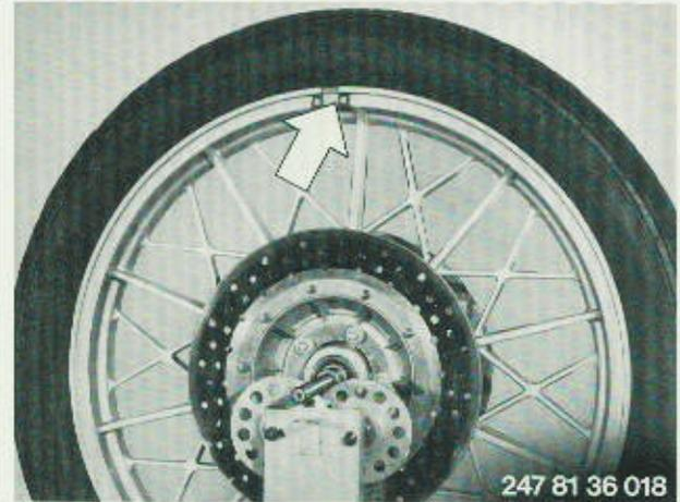
Bei Gußrädern werden die Gewichte mit Hilfe der Montagezange BMW-Nr. 36 3 830 montiert.
