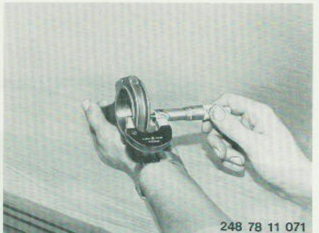
Ist die Verschleißgrenze des Innendurchmessers der Kolbenbolzenbüchse überschritten, Kolbenbolzenbüchse auspressen. Maße s. Techn. Daten.
