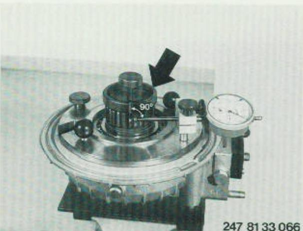
Meßanschlag (Pfeil) im Tellerrad so festklammern, daß der Meßuhrhalter an der Markierung des Meßanschlages im rechten Winkel ansteht.
