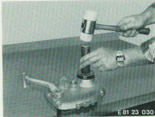
Paßscheiben für Wellenaxialspiel aus Deckel herausnehmen. Dichtring mit Dom aus Deckel herausschlagen. Mit Vorrichtung BMW-Nr. 23 1 750 neuen Dichtring einschlagen.
