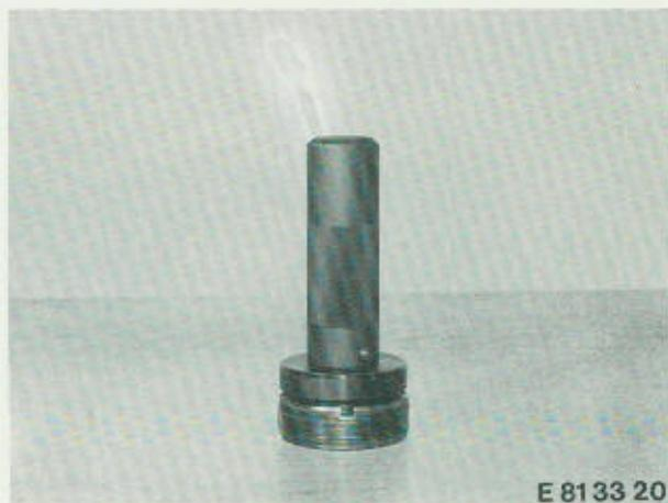
Wellendichtring aus Gewindering mit Dorn Herausschlagen. Neuen Dichtring mit Schlagdorn BMW-Nr. 33 1 750 und Griff BMW-Nr. 00 5 500 einschlagen.
