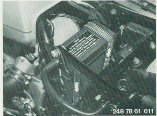
Batterie von der linken Seite aus mit rechter Hand schräg nach hinten und nach oben ziehen. Mit linker Hand die Batterie von unten fassen und die rechte Seite nach vorn und nach oben drehen, die linke Seite nach hinten und nach unten. Damit wird die Lage in der Abb. erreicht.
